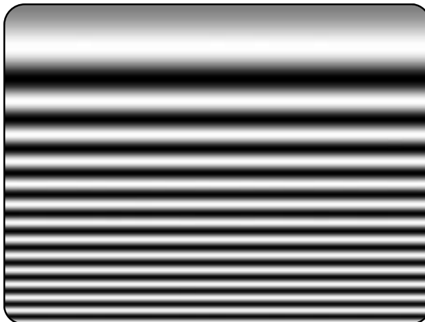
Fig. 20 A “ K_{Y2} -only” zone plate.
